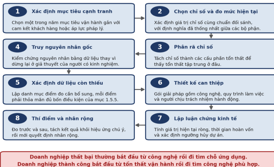
Hình 1.11. Quy trình tám bước chuyển từ chỉ số vận hành sang sáng kiến số hóa
