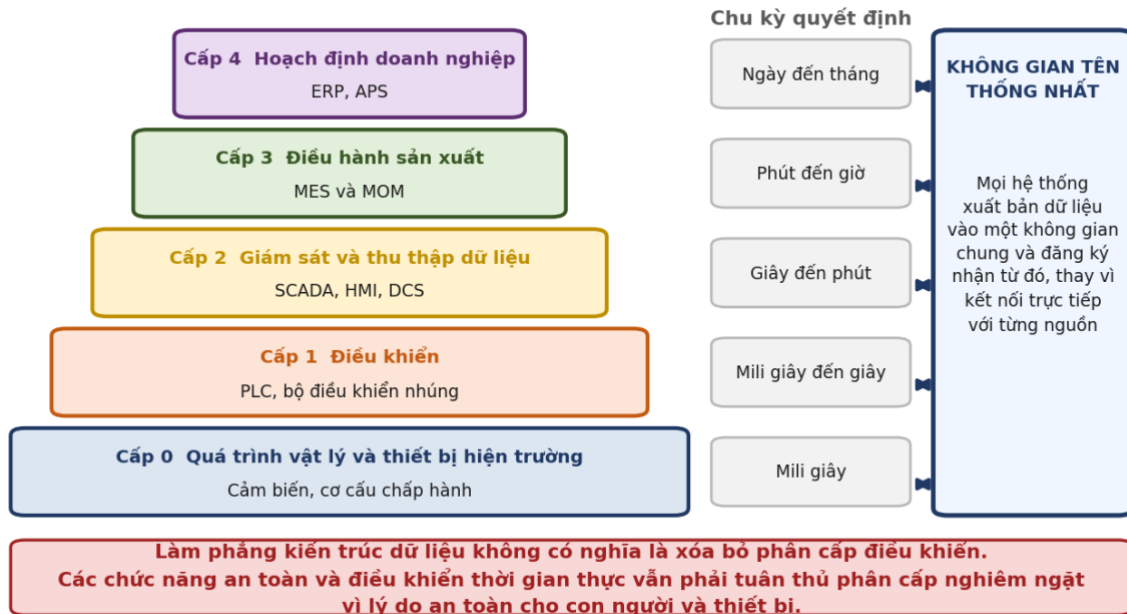
Hình 1.13. Tháp tự động hóa năm cấp và xu hướng làm phẳng kiến trúc dữ liệu
