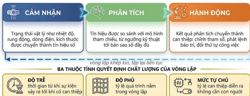
Hình 1.5. Vòng lặp cảm nhận, phân tích và hành động của hệ thống thực ảo trong nhà máy
