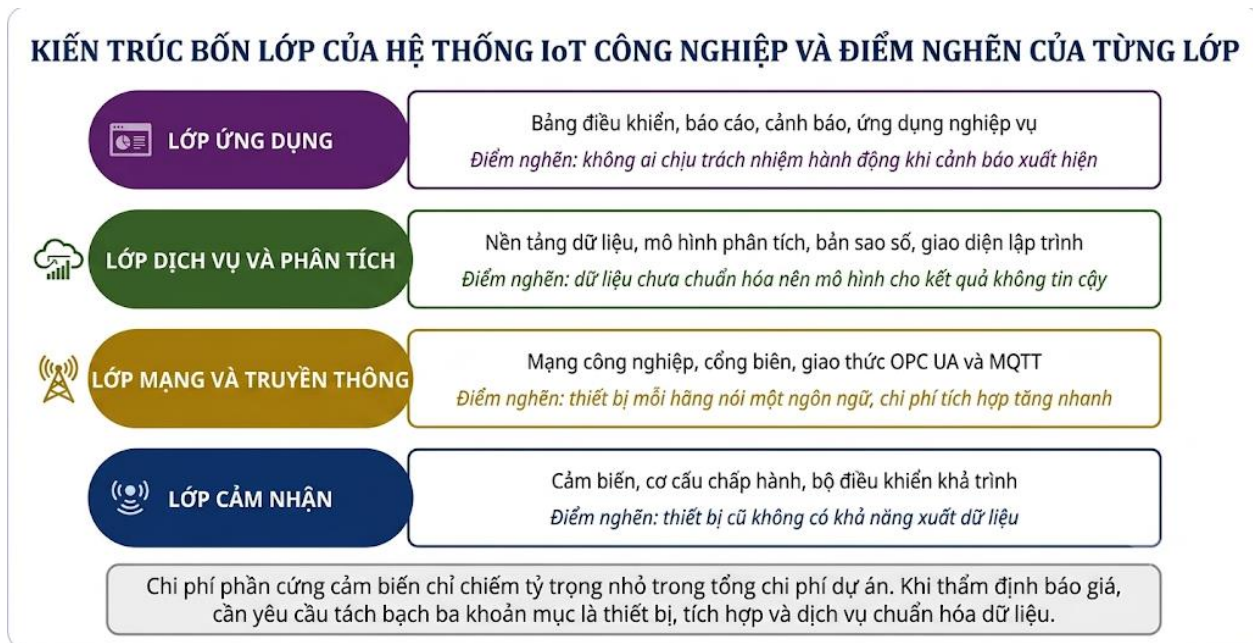
Hình 1.12. Kiến trúc bốn lớp của hệ thống IoT công nghiệp và điểm nghẽn của từng lớp
