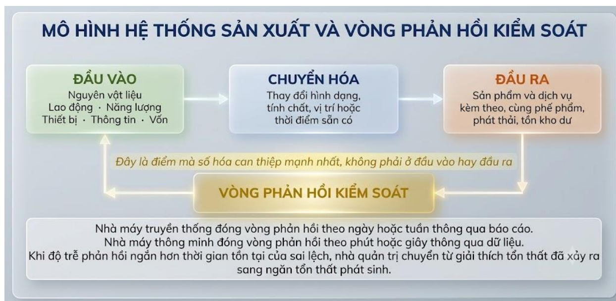
Hình 1.6. Mô hình hệ thống sản xuất và vòng phản hồi kiểm soát
