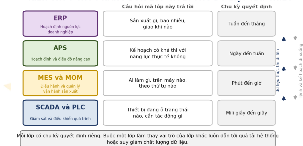
Hình 2.15. Kiến trúc chức năng ERP, APS, MES và SCADA cùng luồng dữ liệu hai chiều
