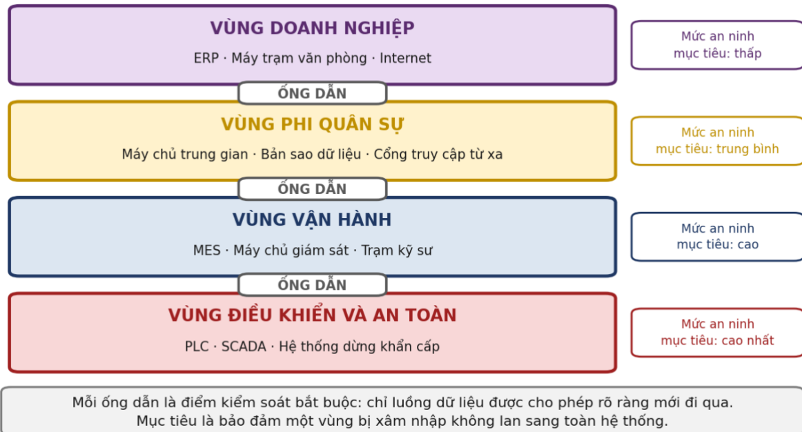
Hình 2.18. Mô hình phân vùng và ống dẫn theo IEC 62443 trong một nhà máy điện hình
