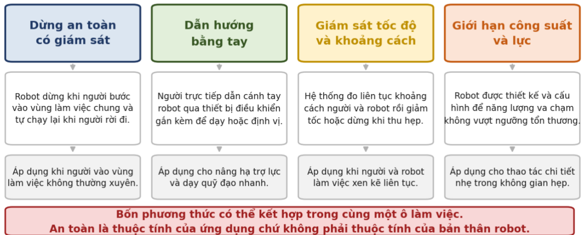
Hình 2.12. Bốn phương thức an toàn trong ứng dụng cộng tác giữa người và robot
