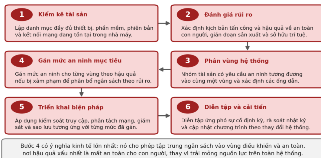
Hình 2.19. Quy trình sáu bước xây dựng chương trình an ninh mạng công nghiệp
