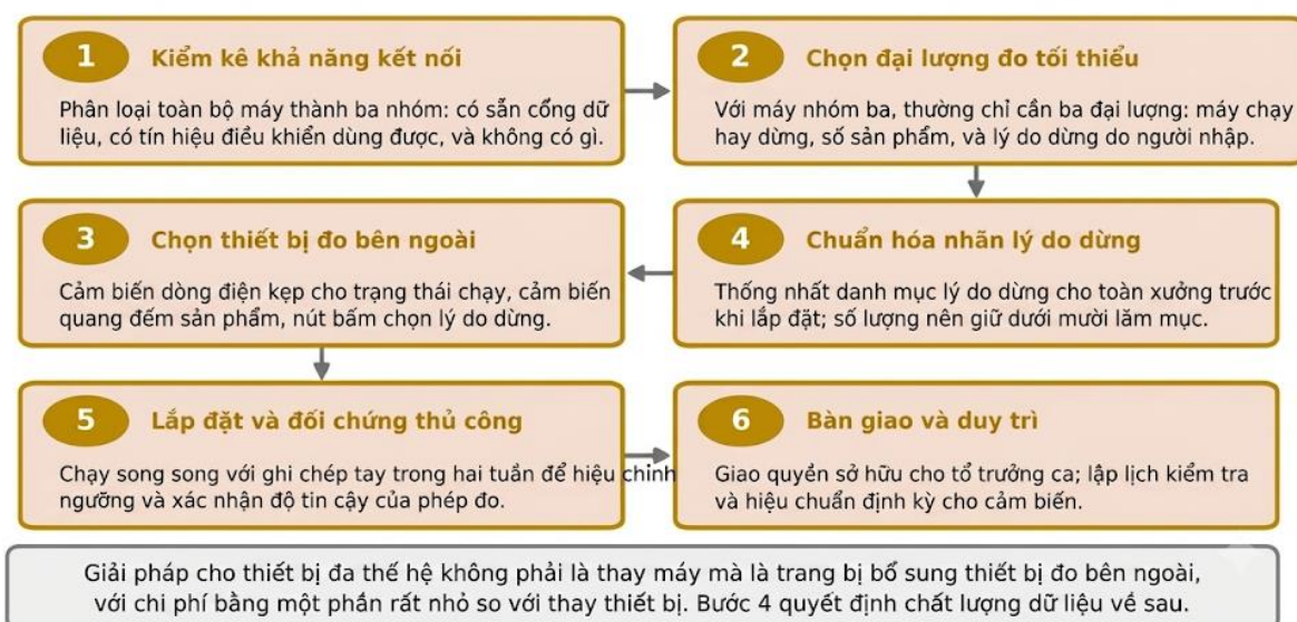
Hình 5.15. Trang bị bổ sung thiết bị đo cho máy cũ thay vì thay thiết bị
